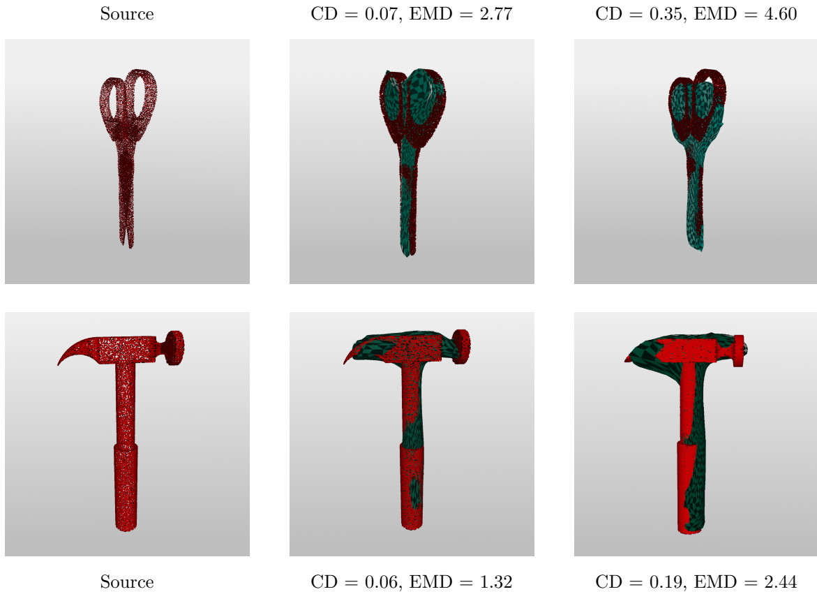
Abbildung 2.4: Vergleich der Chamfer- und Earth-Mover-Distanz für zwei Scheren bzw. Hammer und einer GT-Punktwolke
